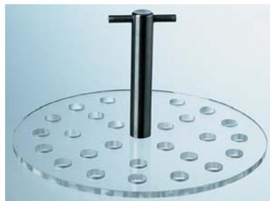
Figura 4.4: El disco de cristal acrílico perforado
