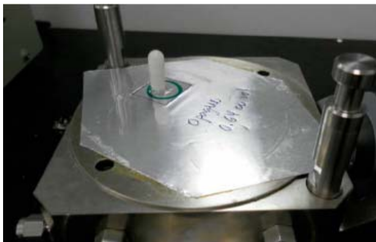
Cápsula entera epoxi con una lámina de test.
